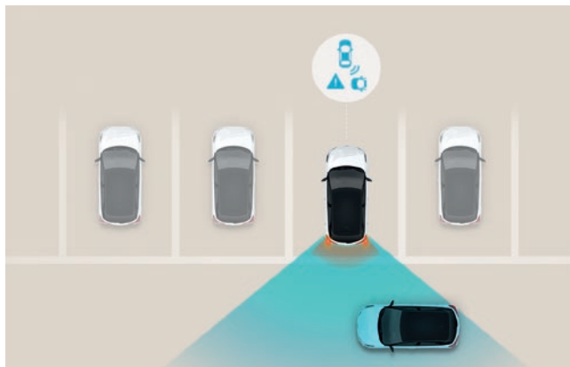
Alerte de circulation transversale arrière avec freinage automatique. En effectuant une marche arrière dans des zones à faible visibilité, le système avertit le conducteur lorsque des véhicules approchent par le côté et freine automatiquement.
